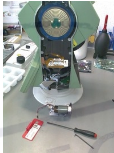
Csúszóérintkezők, a kompenzátor és a V-kör
