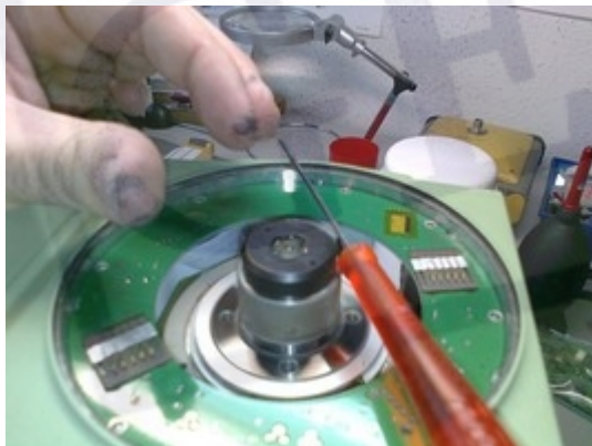
H z -csúszóérintkezők eltávolítása
