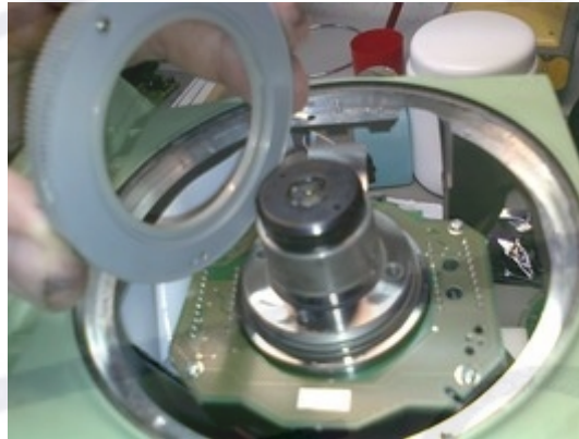
H z -fogaskerék lebontása
